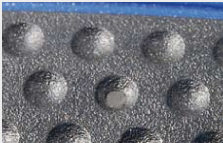
Anspritzpunktposition in sphärischer Vertiefung des Griffteils
